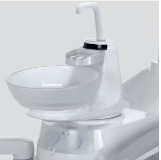
Crachoir avec capteur intégré Le crachoir en verre est démontable et pivotant, ce qui le rend très pratique. Les groupes jet d'eau du verre et du crachoir se démontent et sont autoclavables ; le capteur optique contrôle le remplissage du verre.
